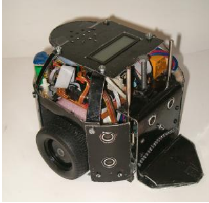
ekil 1 : Ultrasonik sensörler kullandı m sumo robotların “Kara Murat” ve “Battal”
